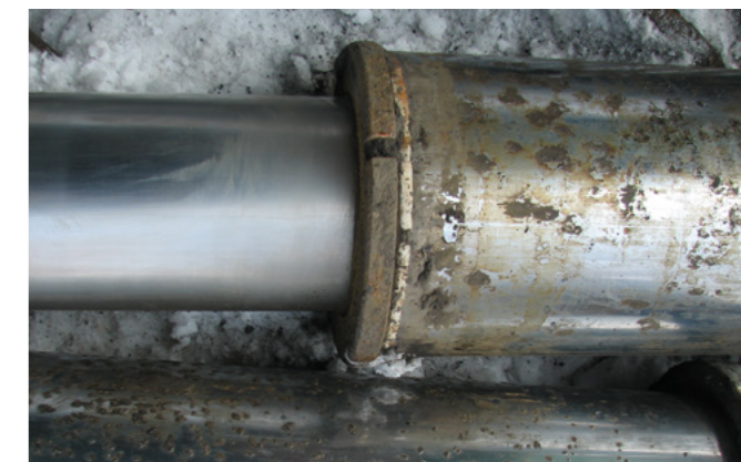
Górnicy stojak hydrauliczny z powłoką DURACHROM na tłoczysku (z lewej) i standardową powłoką ochronną na rdzenniku (z prawej) po dwuletniej eksploatacji w kopalni węgla kamiennego
