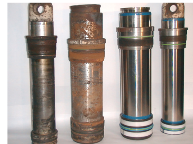
Rdzenniki stojaka hydraulicznego przed i po regeneracji z zastosowaniem powłoki DURACHROM i uszczelnień produkcji FAMUR
