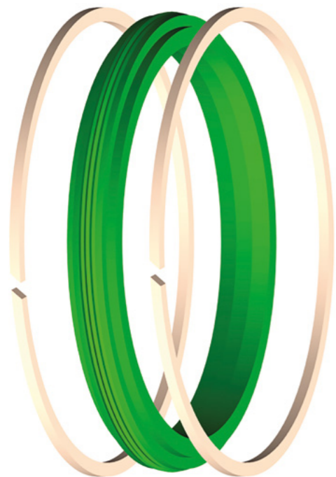
Poz. 1 Pierścień uszczelniający modyfikowany USm (część uszczelniająca - materiał: poliuretan termoplastyczny TPU, twardość 90 \pm 2 ShA) Poz. 2 Pierścień przeciwwyciskowy PPW // (materiał: poliacetal POM)
